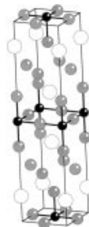
Abbildung 9. Hypothetische Elementarzelle von [BaF_2]_2[AgF_2] . Ag: schwarze Kugeln, Ba: weiße Kugeln, F: graue Kugeln.
