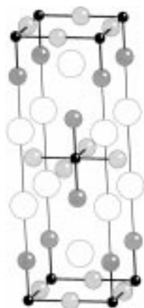
Abbildung 8. Elementarzelle von [CsF]_2[AgF_2] . Man beachte die gestreckte oktaedrische Koordination der Ag^{II} -Zentren. Ag: schwarze Kugeln, Cs: weiße Kugeln, F: graue Kugeln.
